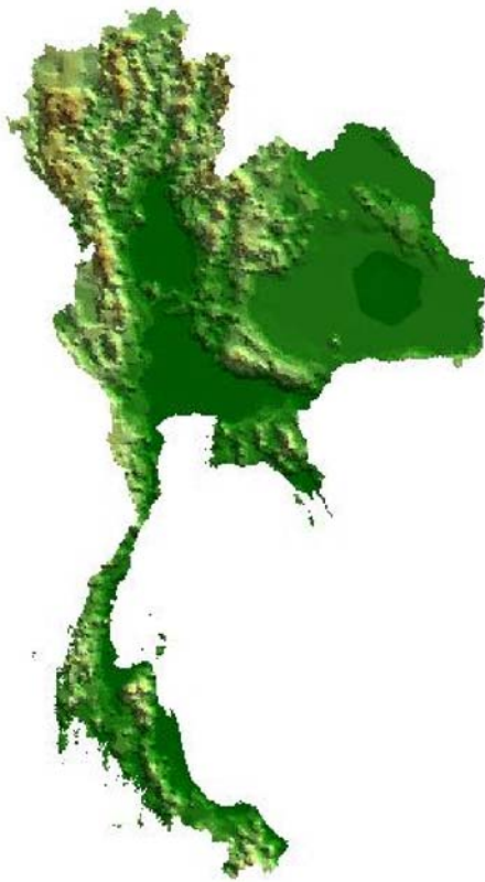
รูปแสดงการสร้างข้อมูลในรูปแบบ TIN ของประเทศไทย โดยจำลองความสูงจากเส้นชั้นความสูง (Contour Line)
